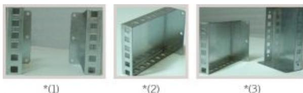
La gama ICT, puede incorporar opcionalmente soportes de equipos de telecomunicaciones (ver 1, 2,3), que con fijación en el panel de madera, cuenta con mecanizaciones en formato 19" con capacidad para 2U tanto en la parte superior como en la inferior y en el frente\*(ver 2), de forma que permite colocar los equipos en las tres caras.
